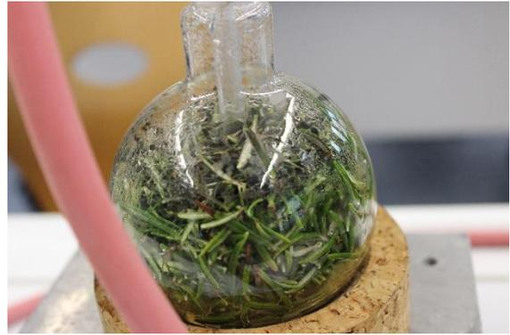
Die Lavendel Blüten wurden in einen Kolben geleert und mit Wasser erhitzt. Am Montag wurde dann Rosmarin erhitzt, das Ergebnis sollte eine Art Duftöl sein. Zuerst wurde Wasser erhitzt, das Wasser verdampft dann und gelangt als Dampf zu den Blüten. Dann wird das Wasser wieder flüssig durch eine Kühlung. Es roch sehr gut.
